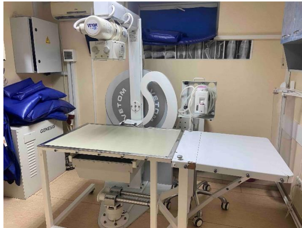
Рисунок 1. Зовнішній вигляд рентгенівського діагностичного цифрового комплексу КРДЦ-02-Альфа, з рентгенівською трубкою IAE RTM 782 HS (рисунок авторів)
