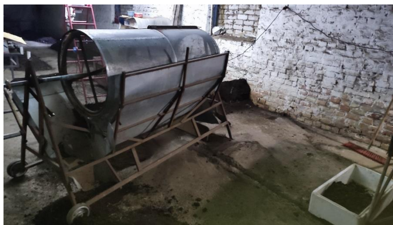
Рисунок 3. Установка для сепарації черв'яків.
