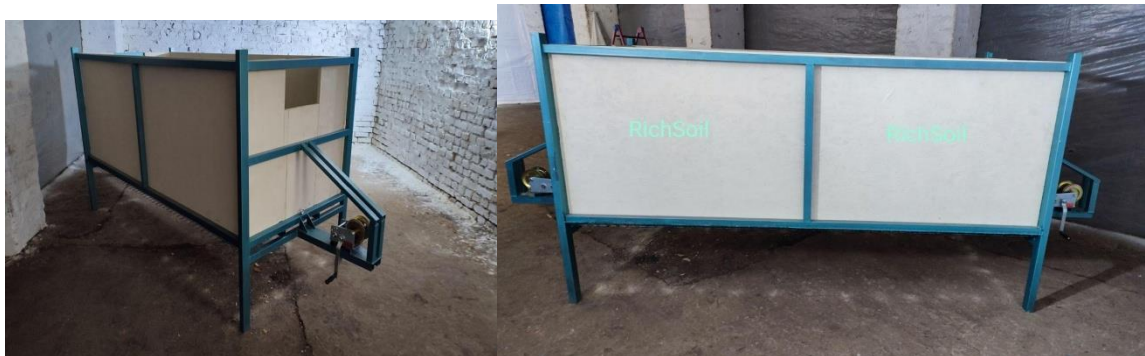
Рисунок 6. Загальний вигляд вермиреактора безперервної дії з ручним приводом
