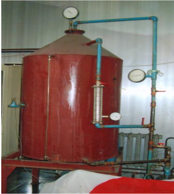
Рис. 2. Загальний вид гідродинамічної установки дезодорації рослинної олії.
