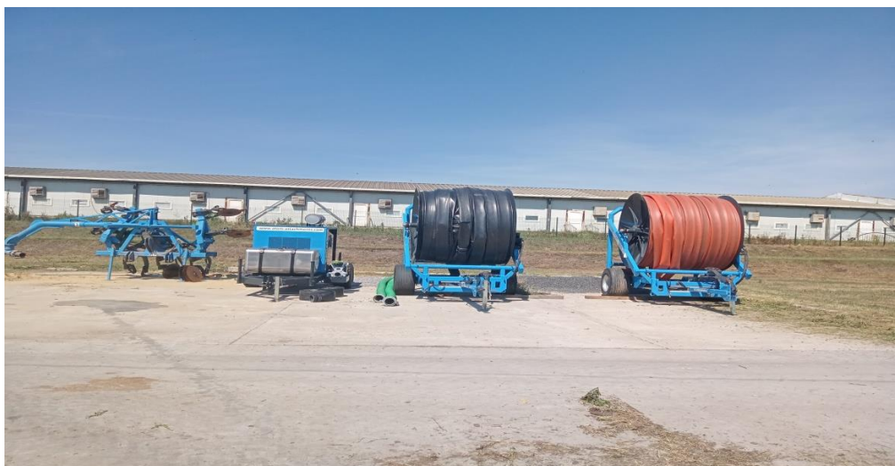
Рис. 2. Обладнання для внесення рідкого гною на поля: зліва направо: 1-інжекторний культиватор для внесення гною А ТОМ 7 DS, 2- насосно-дизельна станція, 3, 4 - причіпні транспортувальники шлангів для гною А ТОМ-2000 (рисунок авторів).
