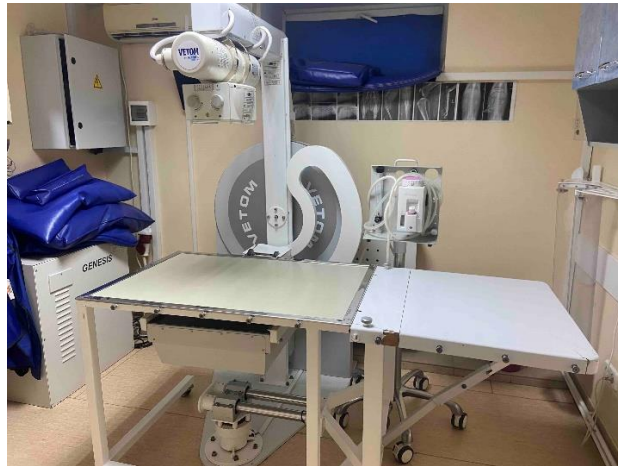
Рисунок 1. Зовнішній вигляд рентгенівського діагностичного цифрового комплексу КРДЦ-02-Альфа, з рентгенівською трубкою ІАЕ RTM 782 HS (рисунок авторів)
